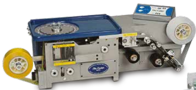
Conditionneuse en dose unitaire 60 ou 120 sachets/minute
