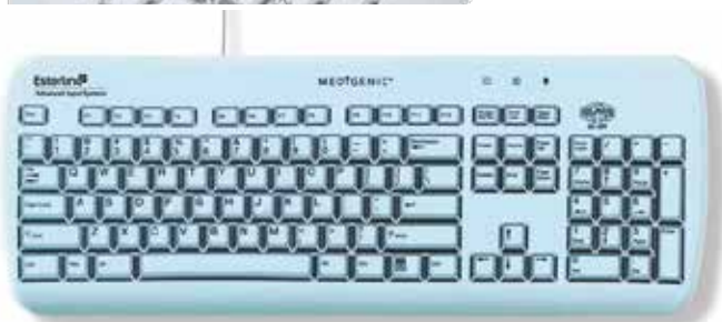
Clavier filaire IP65 MEDIGENIC Dim. : 462 x 170 x H34 mm
